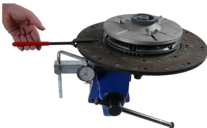
Fig. 8: comprobador de desviación lateral completamente montado
