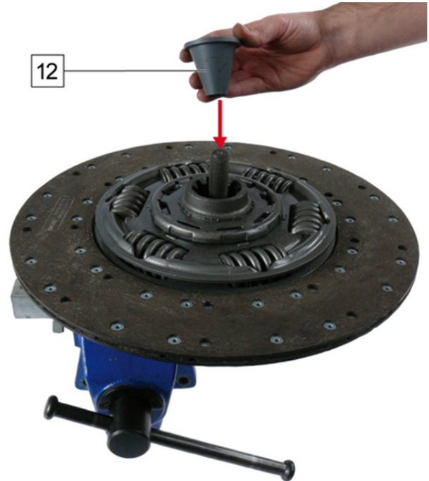
Fig. 4 : Centrer le disque d'embrayage
