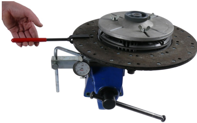
Fig. 8 : Appareil de contrôle du voilage complètement monté
