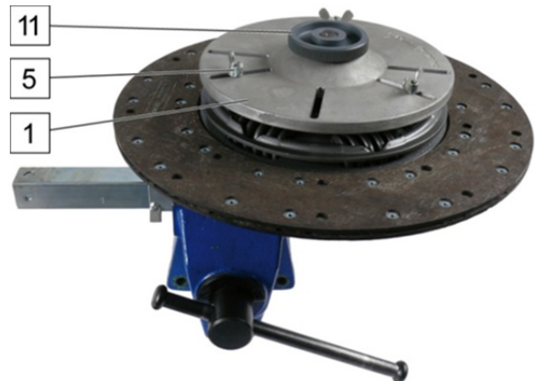
Fig. 5: montaje del plato de soporte
